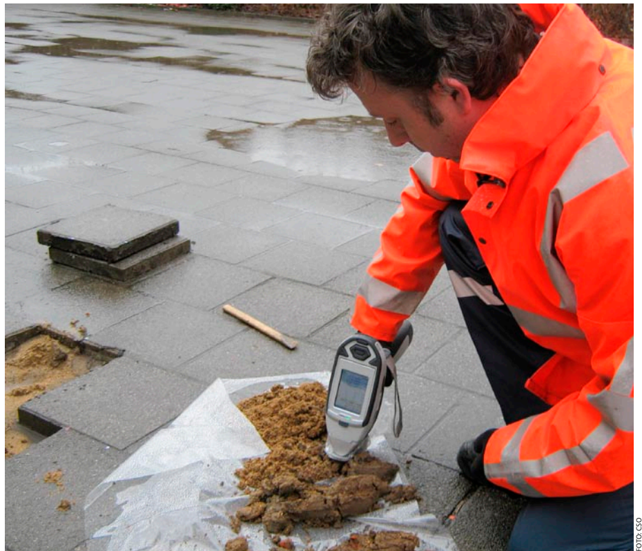
Onderzoeker bepaalt het gehalte aan zware metalen in grond met een XRF-apparaat (röntgenspectrometer).
